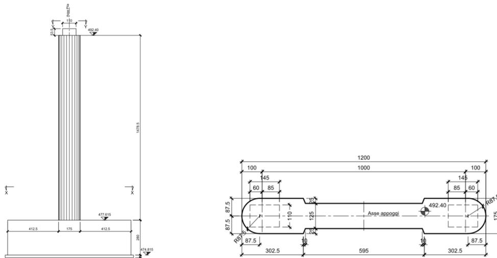
Figura 9 profilo laterale e pianta pila
