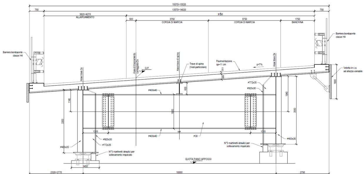
Figura 7 – Sezione trasversale dell'impalcato carreggiata sinistra
