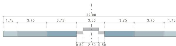
Figura 1 – Schema della sezione stradale in progetto
