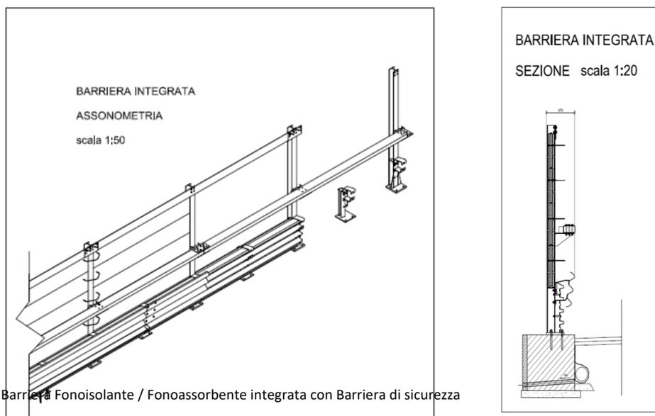
Figura 0-13 Barriera Fonoisolante / Fonoassorbente integrata con Barriera di sicurezza
