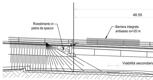
Figura 10 spalla1 rivestimento parti in c.a. con pietra da spacco
