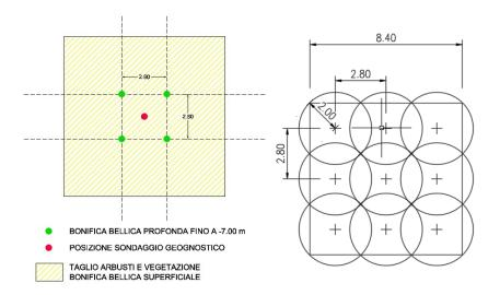
Al centro di ogni area, avviene la perforazione a mezzo di trivella non a percussione, di un foro di diametro maggiore rispetto a quello della sonda dell'apparato di ricerca e comunque, per motivi di sicurezza, non superiore a cm. 20. Si inserisce poi nel foro la sonda dell'apparato di ricerca fino a raggiungere il fondo di questo. Per impedire ingressi indesiderati, l'area di lavoro viene recintata.
