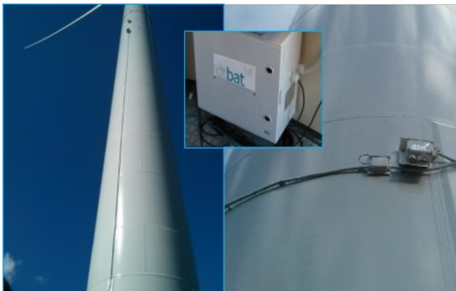
Figura 4 – Esempio di installazione di un sistema automatico su aerogeneratore per abbassare il rischio collisione
