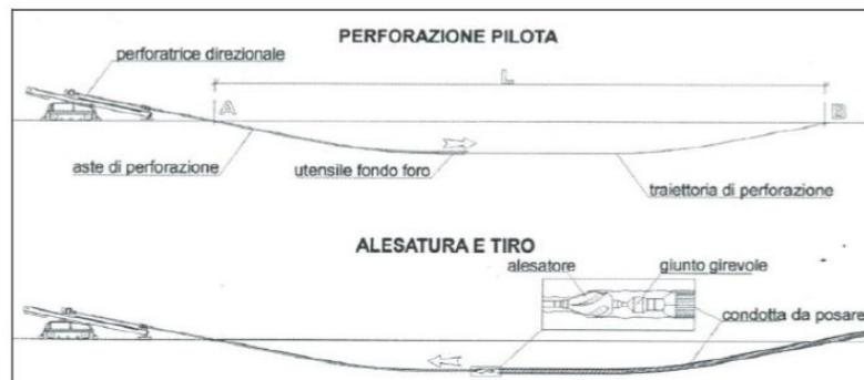
Figura 15: Schematico di trivellazione orizzontale controllata.
