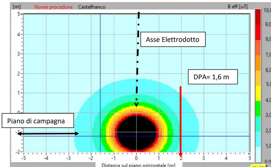
Fig.4 Mappa verticale induzione magnetica (B) sezione tipo con indicazione della DPA - V=30 kV I = 624 A
