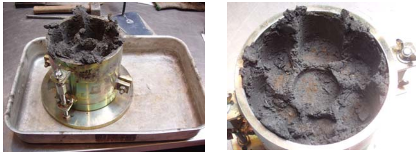
Figura 6.3 – Materiale a fine compattazione dopo 1 ora (A), 2 giorni (B).
