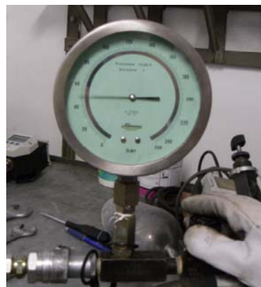
Figura 5.4 - Pressione applicata dalla pompa oleodinamica durante la prova MML-A.
