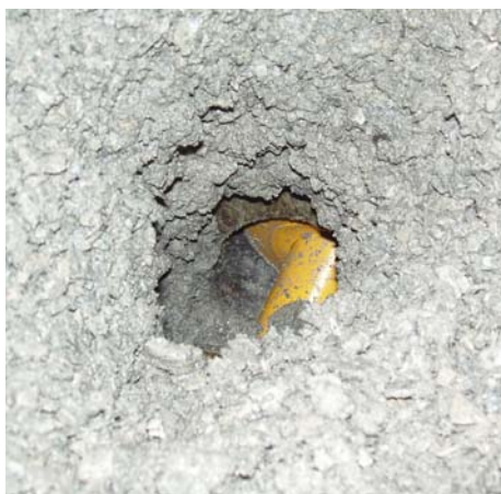
Figura 5.5 - Vuoto nel materiale creato dalla rotazione della coclea.
