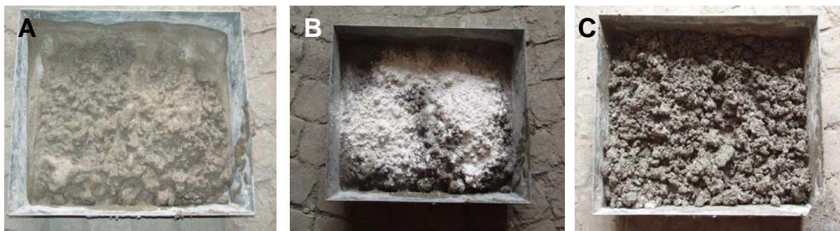
Figura 6.5 – Fasi di stabilizzazione a calce del materiale condizionato. Prima (A), durante (B) e dopo (C) l'aggiunta della calce.
