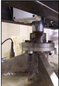
Sensore di posizione
