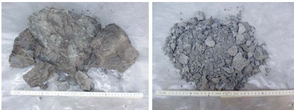
Figura 2.1 – Aspetto visivo della formazione del Sillano prima della frantumazione (sinistra) e dopo (destra)
