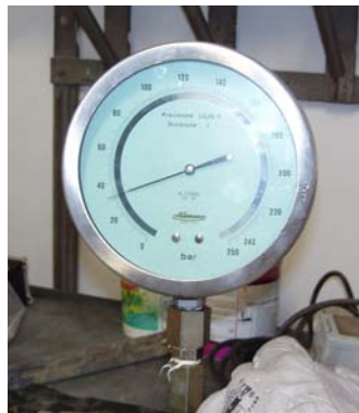
Figura 5.6 - Pressione applicata dalla pompa oleodinamica durante la prova MML- B.
