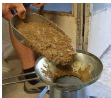
Una volta creato il mix vengono riempiti i coni di slump
