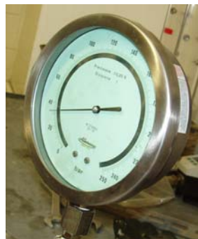
Figura 5.7 - Pressione applicata dalla pompa oleodinamica durante la prova SIL-B.
