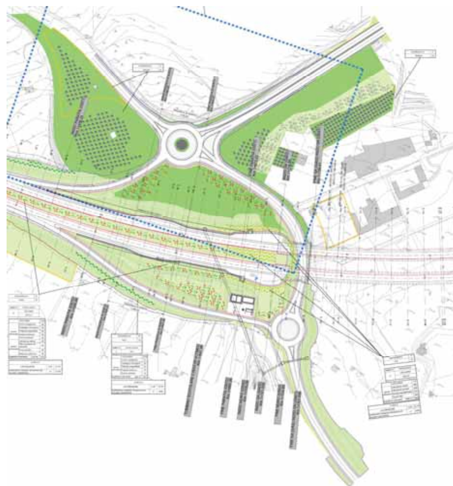
Figura 5-25. Estratto della Planimetria delle opere a verde relativa allo svincolo 8 Francofonte lato Ovest con le modifiche previste da PE.
