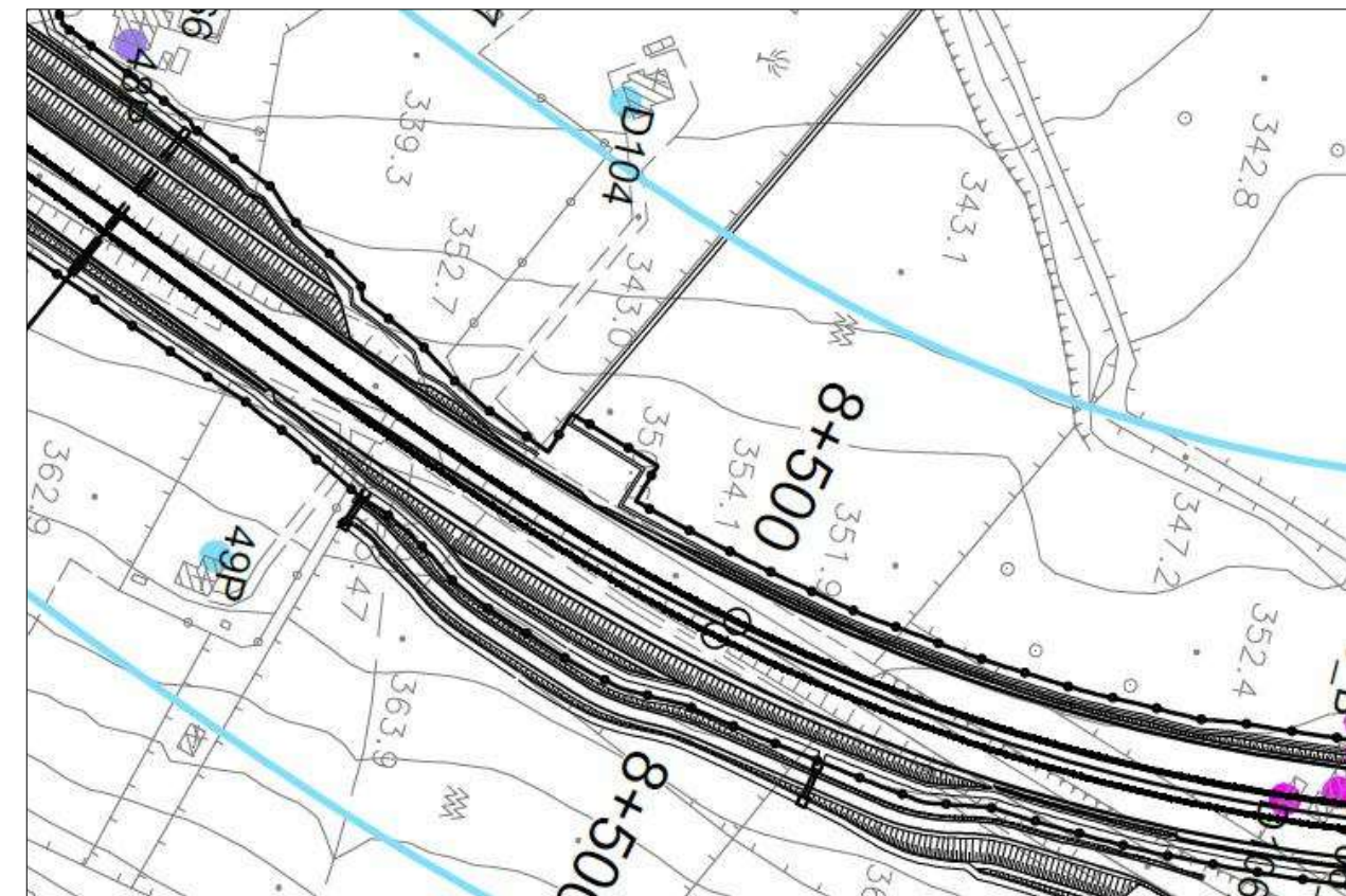
Estratto non in scala della Tavola "Planimetria dei ricettori, dei punti di misura e Zonizzazioni acustiche comunali" presso l'area di progetto della variante
