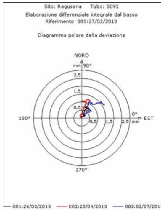
Figura 6.10 misure inclinometriche S091
