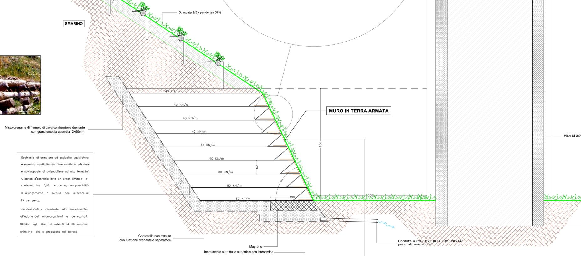
Geotessile di armatura ad esclusiva agugliatura meccanica costituito da fibre continue orientate e sovrapposte di polipropilene ad alta tenacità. A carico d'esercizio avrà un creep limitato e contenuto tra 5/8 per cento, con possibilità di allungamento a rottura non inferiore al 45 per cento. Imputrescibile, resistente all'invecchiamento, all'azione dei microrganismi e dei roditori. Stabile agli U.V. ai solventi ed alle reazioni chimiche che si producono nel terreno.
