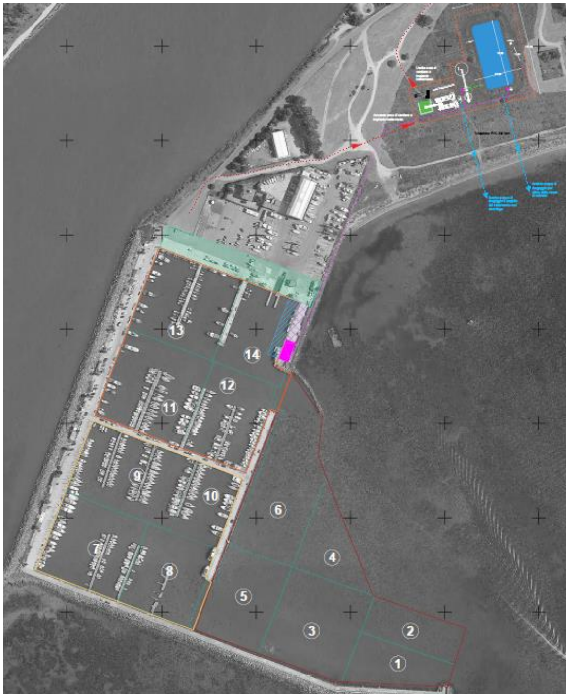
Figura 37 – Indicazione area proposta per l'installazione degli impianti di trattamento dei materiali dragati.
