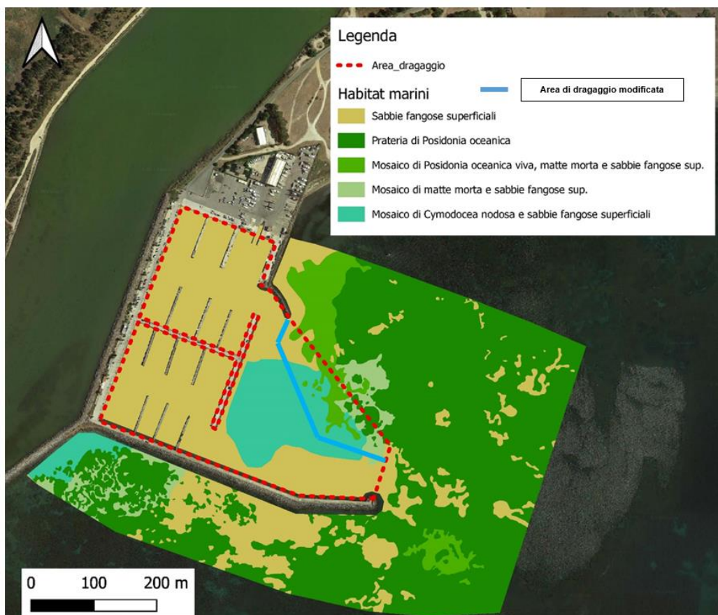
Figura 35 - Perimetrazione nuova area di escavo.
