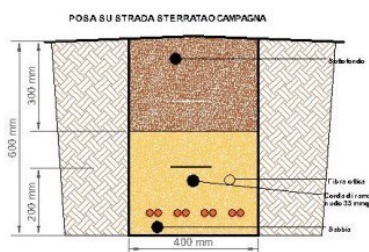
Figura 9: Particolare sezione tipo cavo interrato BT
