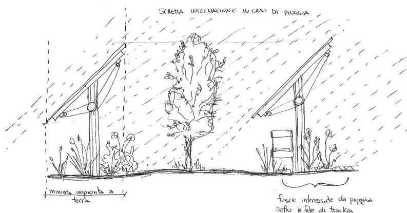
Figura 31 - Schemi interferenze pioggia
