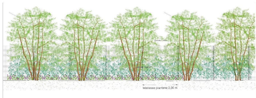
Figura 30 - Prospetto recinzione perimetrale con mitigazione
