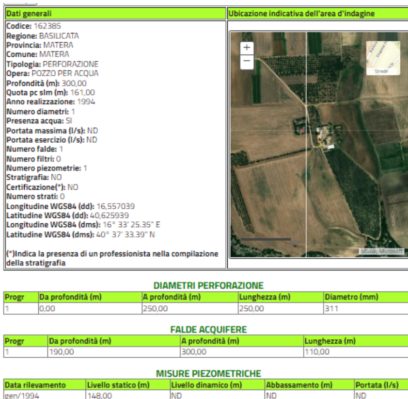
Fig. 6 - Lo schema in figura rappresenta le caratteristiche principali del pozzo in questione. La distanza tra sito e pozzo è di qualche Km con quote altimetriche simili.
