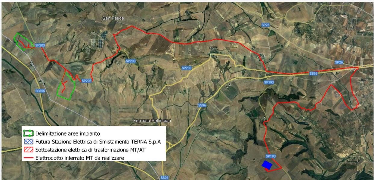
Figura 3 - Percorso dell'elettrodotto interrato MT da realizzare (tratto in rosso)
