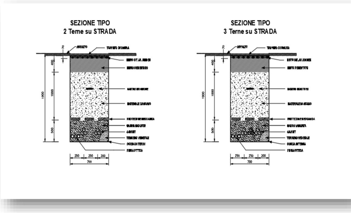
Figura 42- Posa elettrodotto interrato MT 30kV (a doppia e tripla terna)
