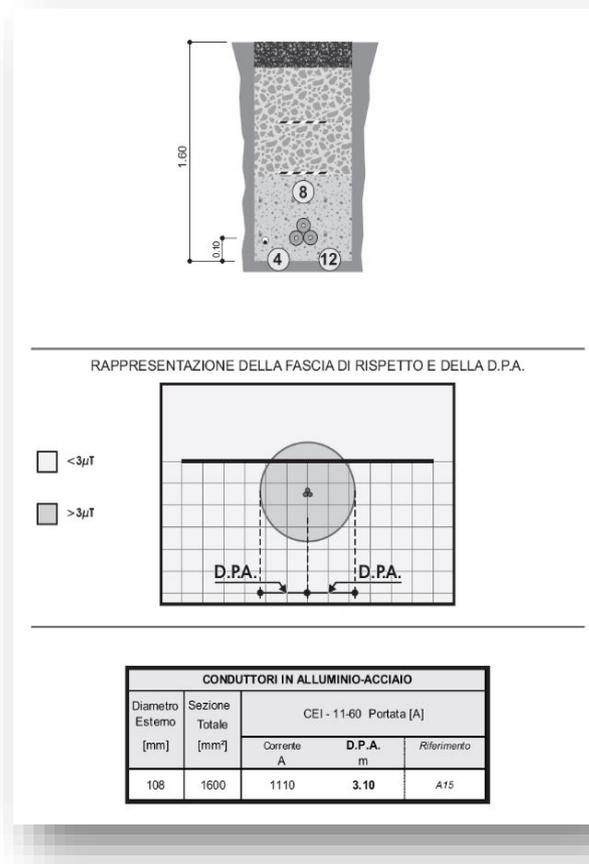
Figura 41-Sezione cavidotto e DPA elettrodotto interrato AT
