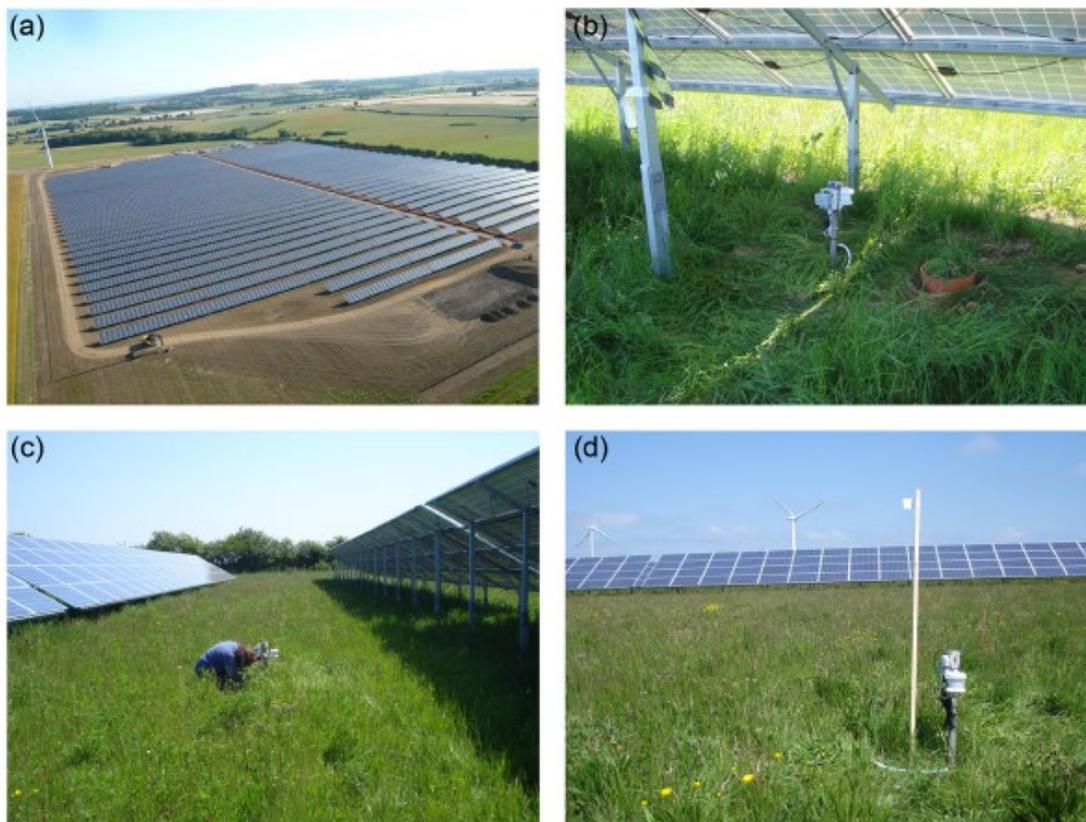
Figura 31- (a) foto aerea del Westmill Solar Park; (b) Under: punto di rilevamento sotto i moduli; (c) Gap: punto di rilevamento tra i filari di moduli; (d) Control: punto di rilevamento esterno
