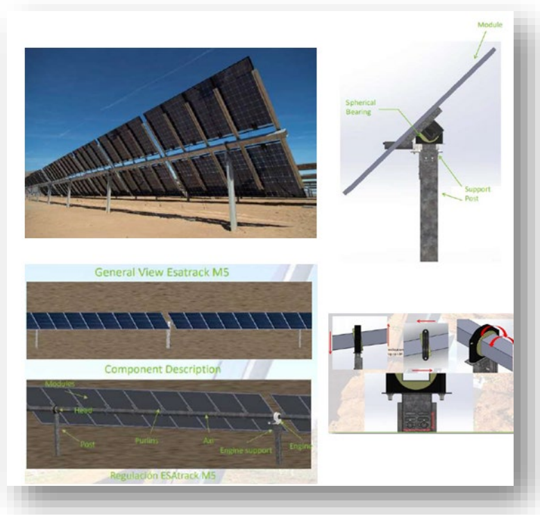
Figura 9 - Strutture di sostegno e sistema di inseguimento solare
