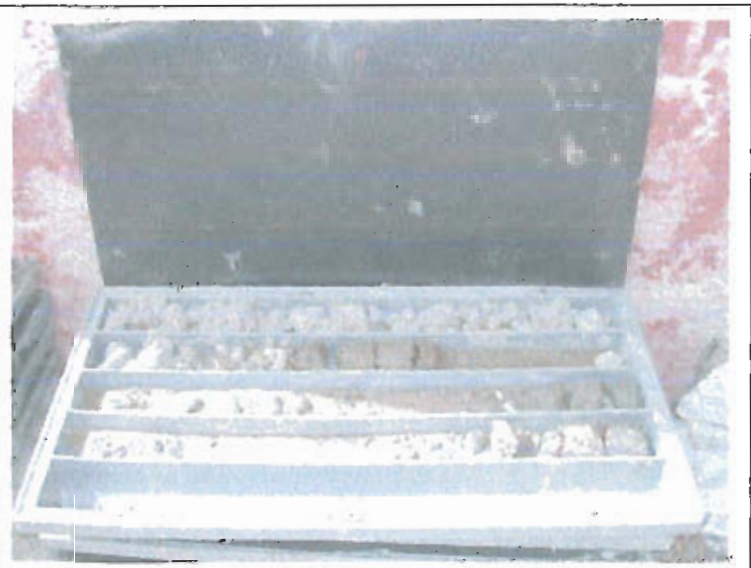
Sondaggio S4 - Cassetta C3 da 11.00 m a 17.50 m
