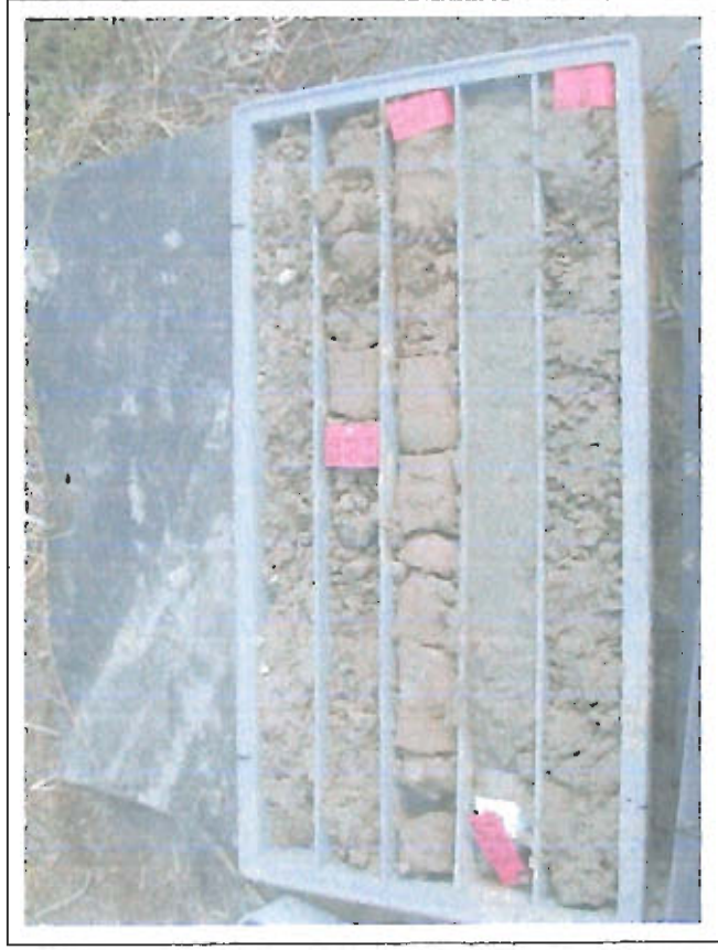
Sondaggio S1 - Cassetta C3 da 10.50 m a 15.50 m
