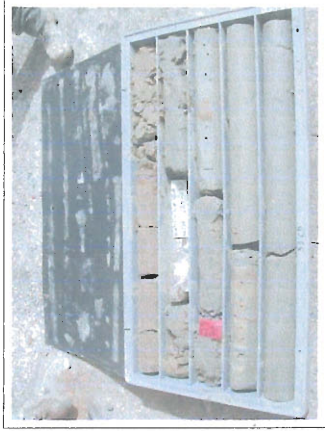
Sondaggio S1 - Cassetta C5 da 20.50 m a 26.50 m
