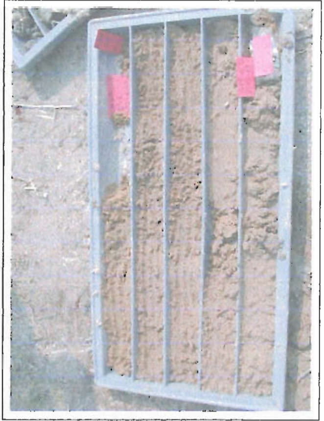
Sondaggio S1 - Cassetta C2 da 5.00 m a 10.50 m
