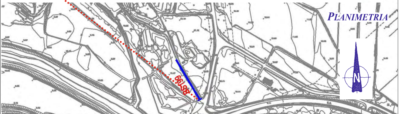
Geometria stendimento geofonico da 115 ml
