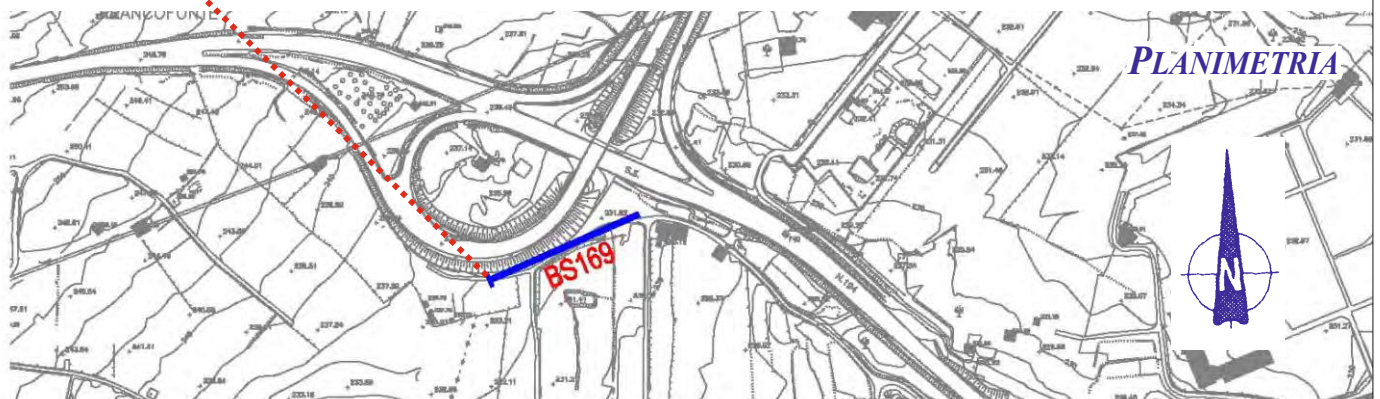
Geometria stendimento geofonico da 115 ml
