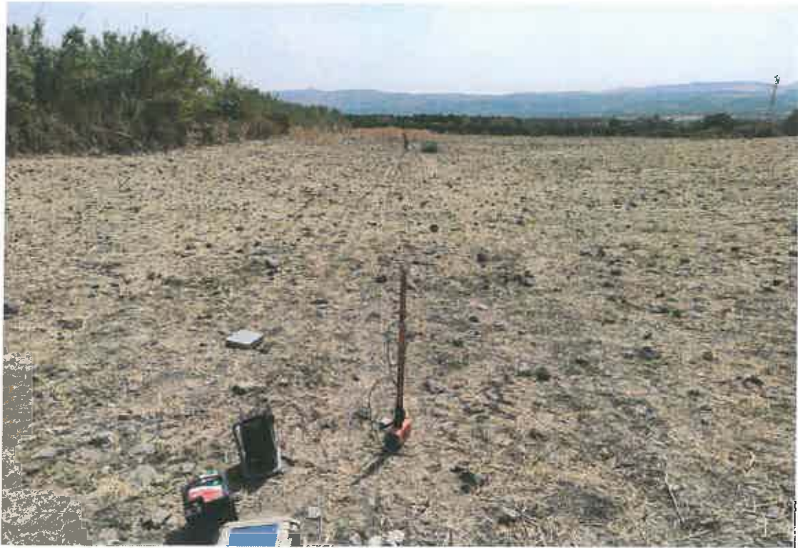
Esecuzione della prova M.A.S.W. ME208
