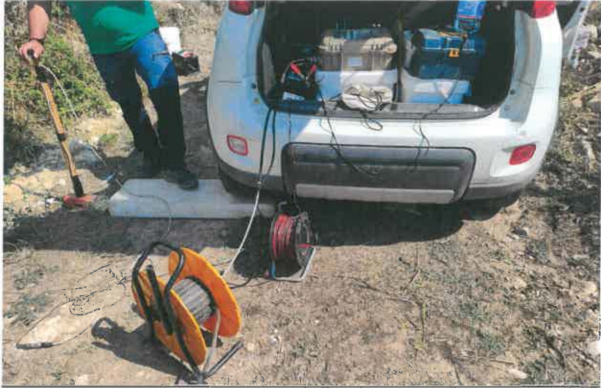
Foto 1 - Esecuzione della prova geofisica Down-Hole
