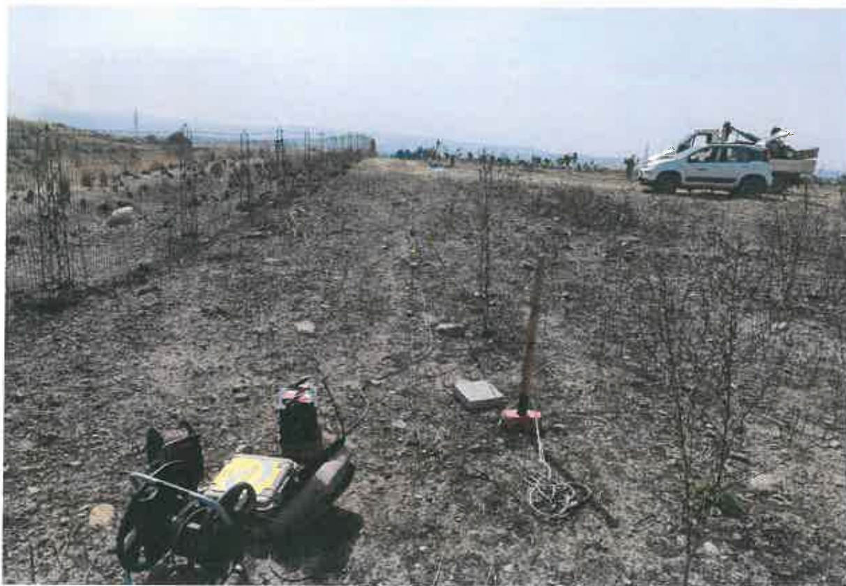
Esecuzione della prova M.A.S.W. ME215
