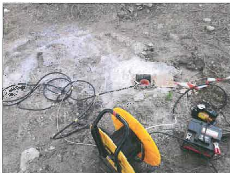
Geofono 3D in foro ad ancoraggio pneumatico
