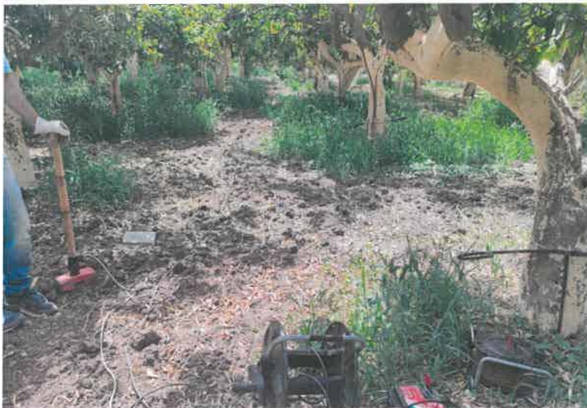
Esecuzione della prova M.A.S.W. ME211
