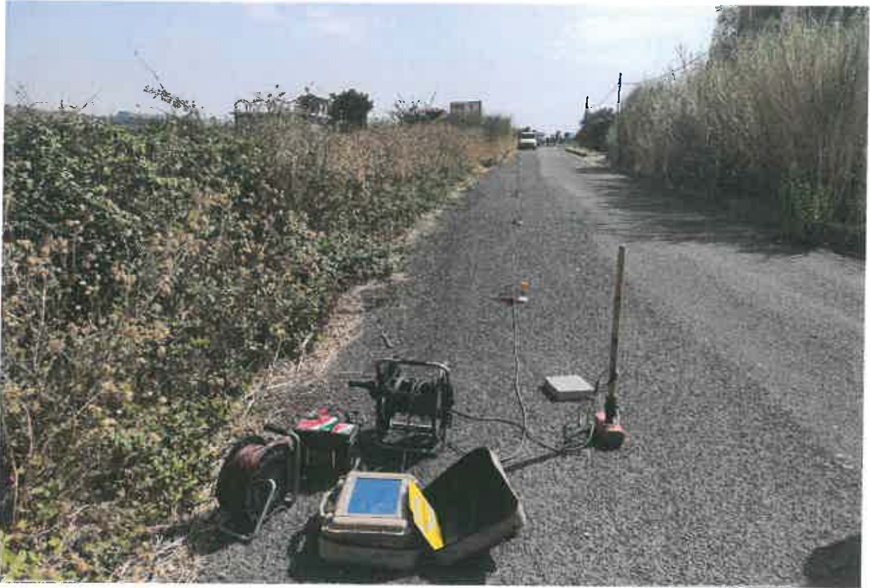
Esecuzione della prova M.A.S.W. ME217
