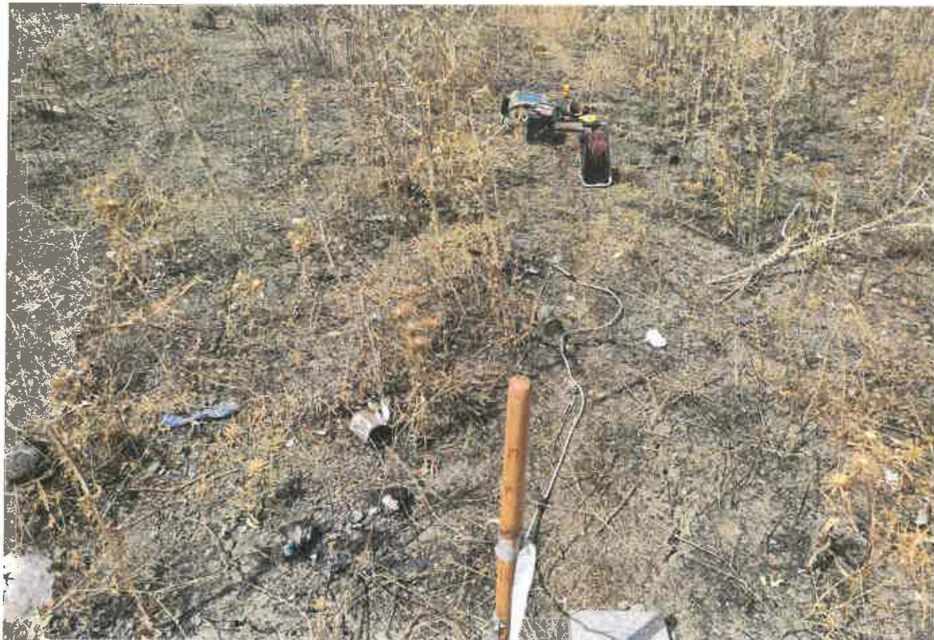
Esecuzione della prova M.A.S.W. ME213
