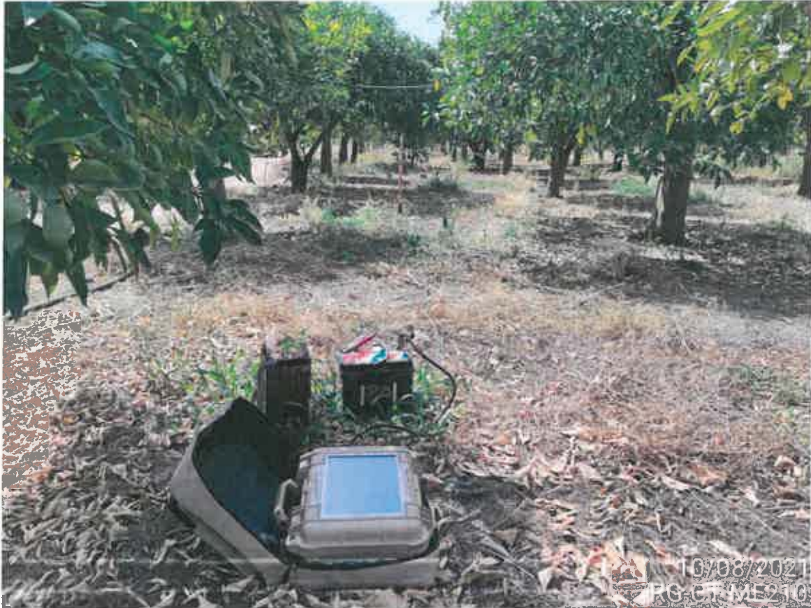
Esecuzione della prova M.A.S.W. ME210
