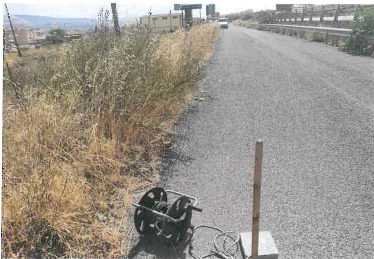
Esecuzione della prova M.A.S.W. ME216
