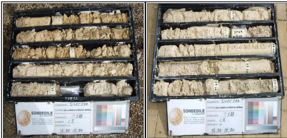
Figura 26: Unità geotecnica Qc(a), foto cassette del sondaggio S188 (da 10 a 20 m).
