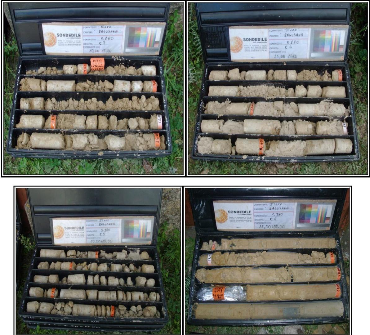
Figura 14: Unità geotecnica Qcs, cassette catalogatrici (S180, da 10 a 30 m).
