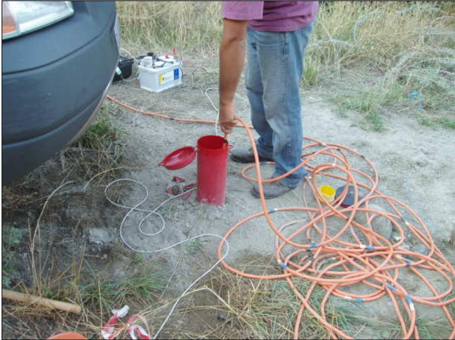
*Foto 1: Preparazione della prova con inserimento della terna geofonica.*
