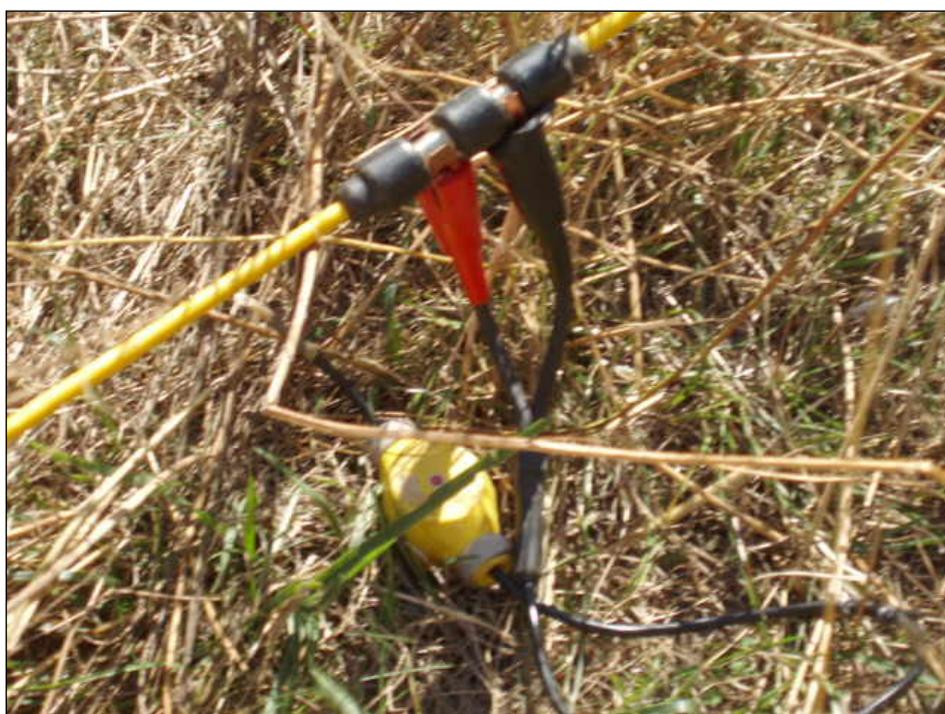
*Foto 2: Particolare di un geofono e del suo cavo di collegamento.*
