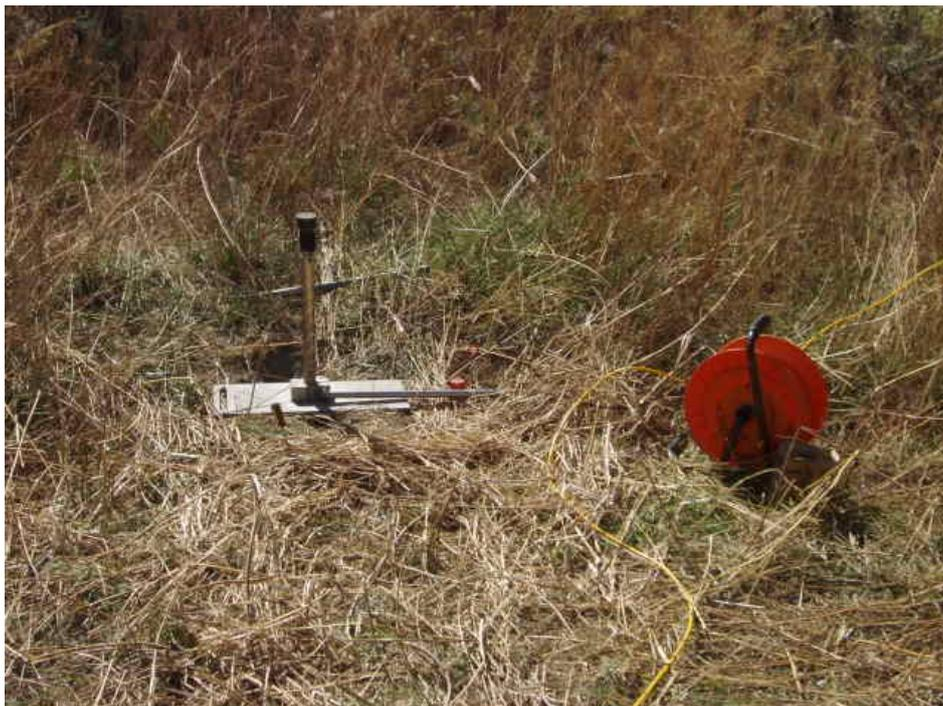
*Foto 3: Particolare dell'energizzatore: fucile mini-bang.*
