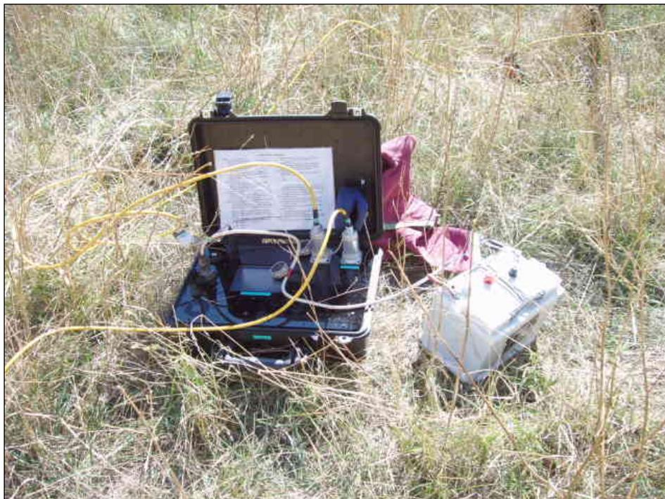
*Foto 1: Unità di acquisizione dati pronta per lo stendimento n. 1.*
