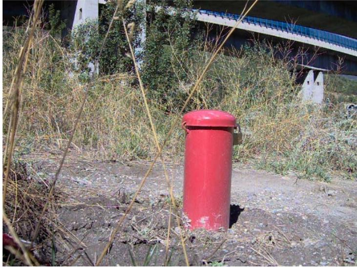
*Particolare fotografico del tipo di terminale di protezione adottato*
