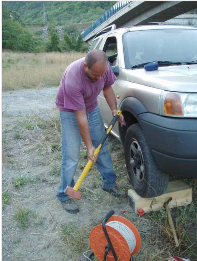
*Foto 3: Fase di energizzazione con massa battente in direzione orizzontale.*
