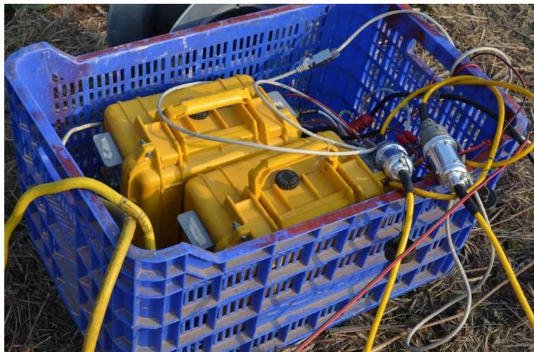
**Figura 11 – Coppia di sismografi Geometrics Geode.**
