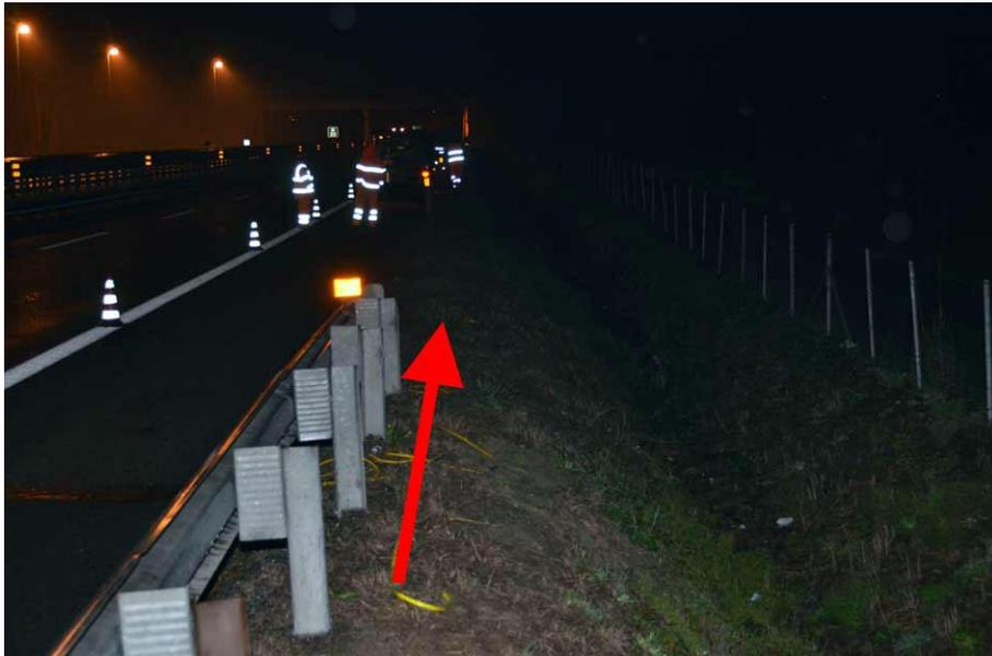
**Figura 3 – IS3 - Ubicazione planimetrica (in rosso lo stendimento sismico, fuori scala) - Foto dello stendimento (la freccia indica l'inizio linea e l'orientazione).**
