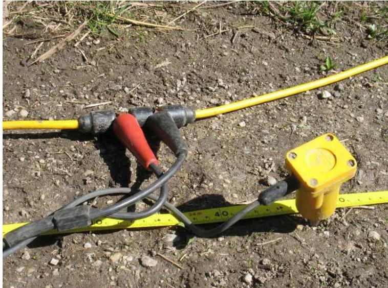
**Figura 12 – Geofono verticale SENSOR SM-6/U-B.**
