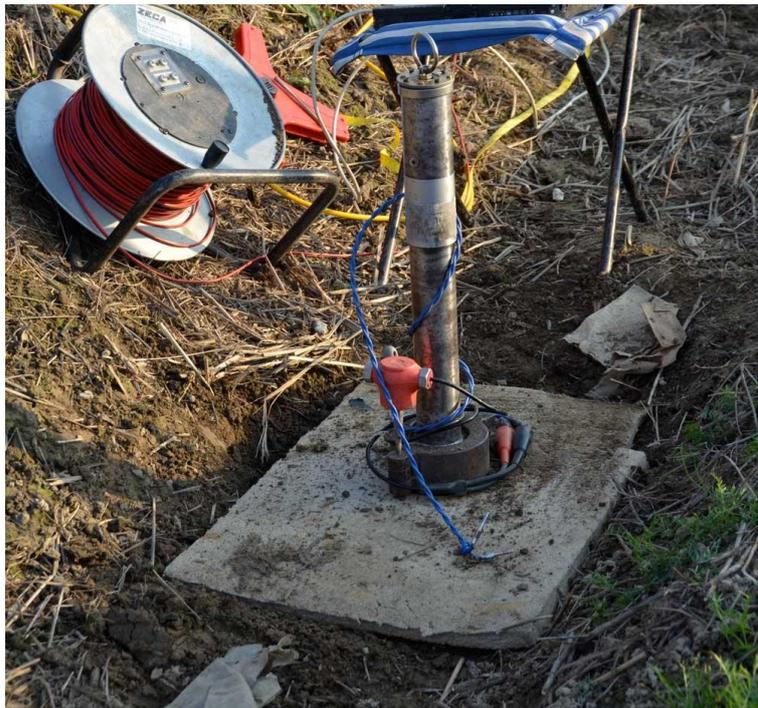
**Figura 13 – Fucile sismico.**
