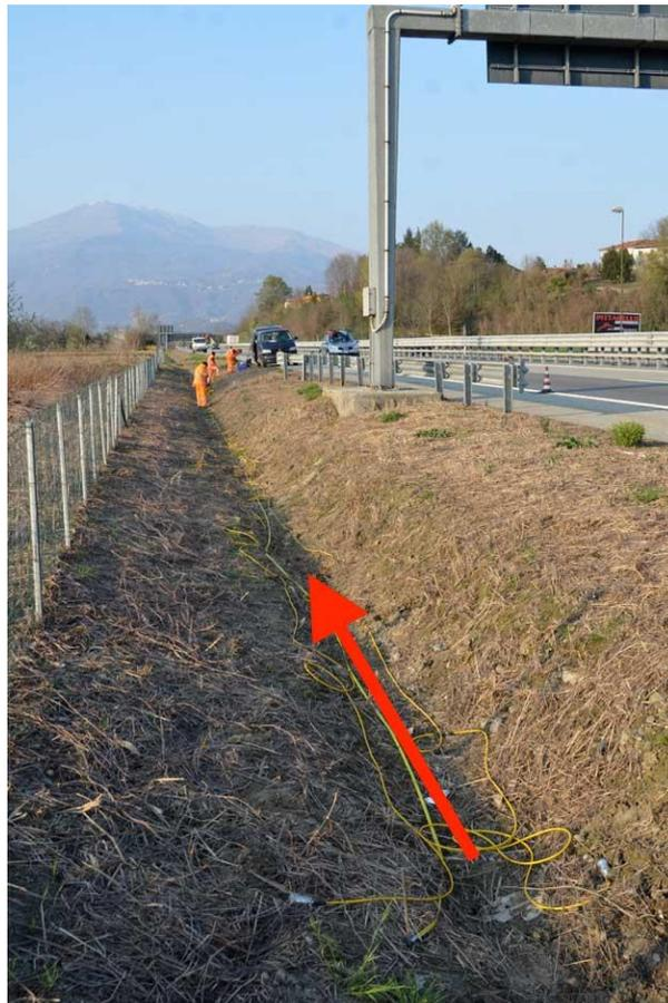
**Figura 5 – IS5 - Ubicazione planimetrica (in rosso lo stendimento sismico, fuori scala) - Foto dello stendimento (la freccia indica l'inizio linea e l'orientazione).**
