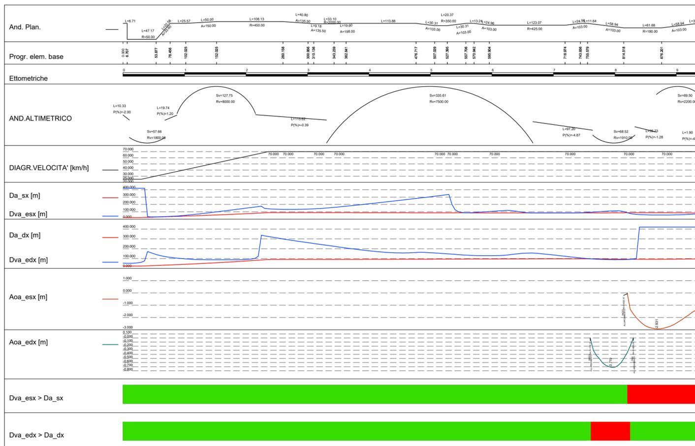
NOTA: L'allargamento richiesto è stato predisposto sia in planimetria che sulle sezioni. L'allargamento "edx" è inglobato all'interno dell'allargamento "esx".
