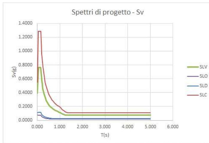
Figura 4.2 : Spettro elastico per la componente verticale
