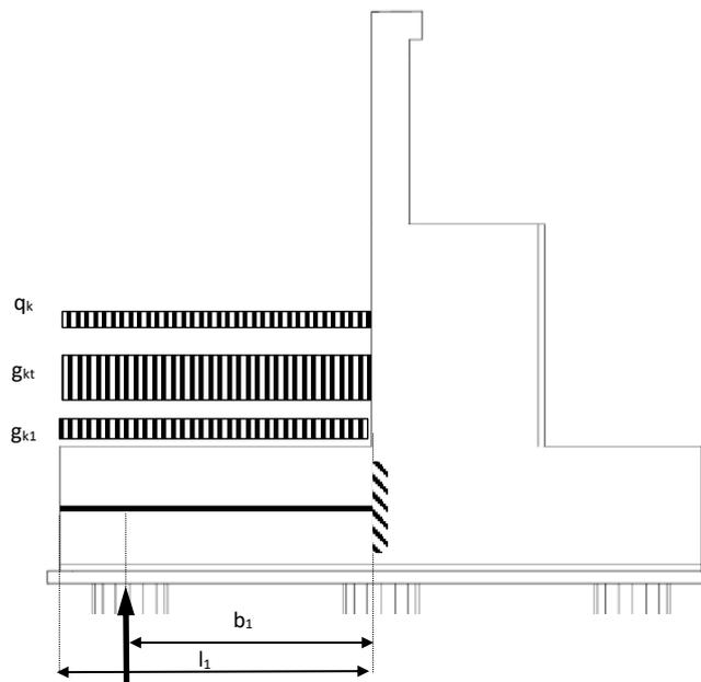
Figura 10.19 schema di calcolo suola posteriore
