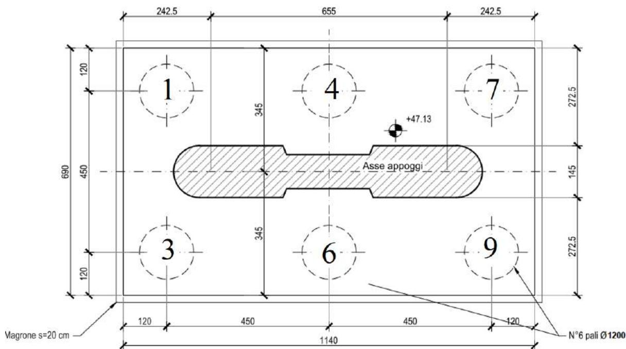
Figura 10.5: Pianta del plinto con numerazione pali
