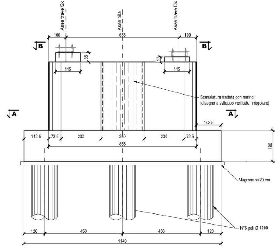
Figura 10.3: Vista del plinto in sezione trasversale impalcato
