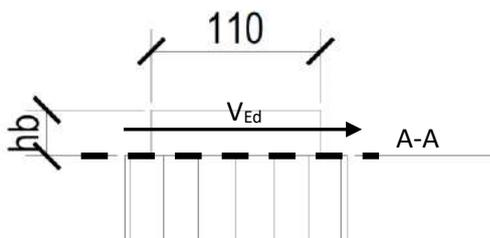
Figura 10.2 Sezione di verifica mecc. "shear friction "
