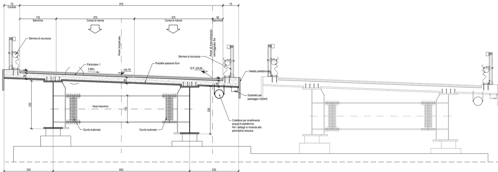
Sezione trasversale su pila sx
