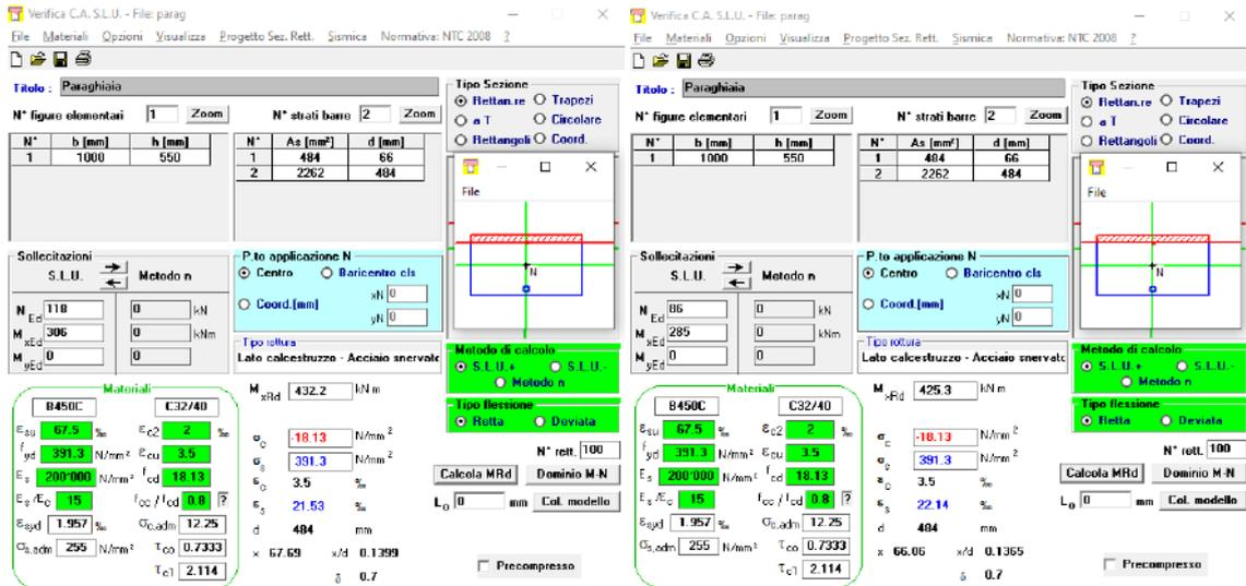
Come si può notare, in ambedue i casi si rileva un rapporto di sfruttamento M<sub>Ed</sub>/M<sub>Rd</sub> inferiore all'unità, e, in particolare:
