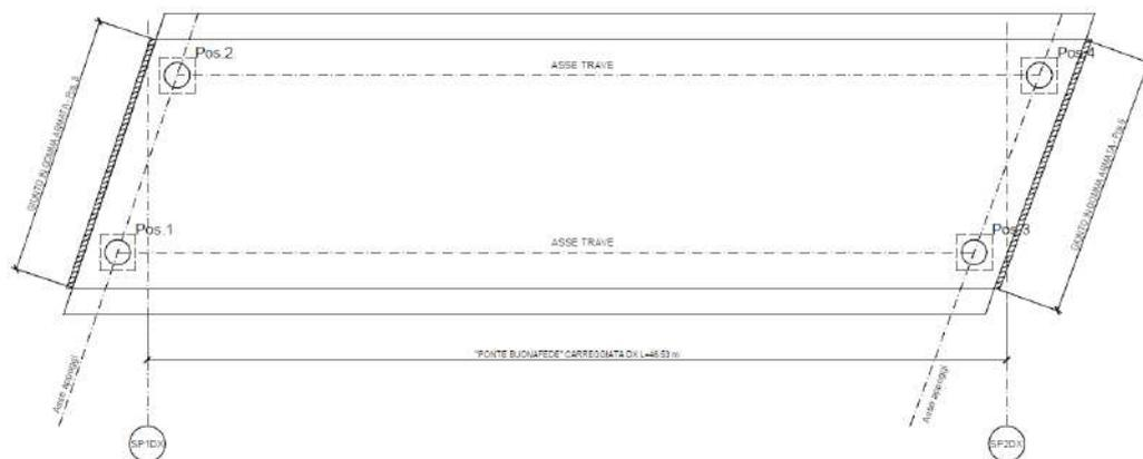
Figura 11.1 Pianta appoggi
