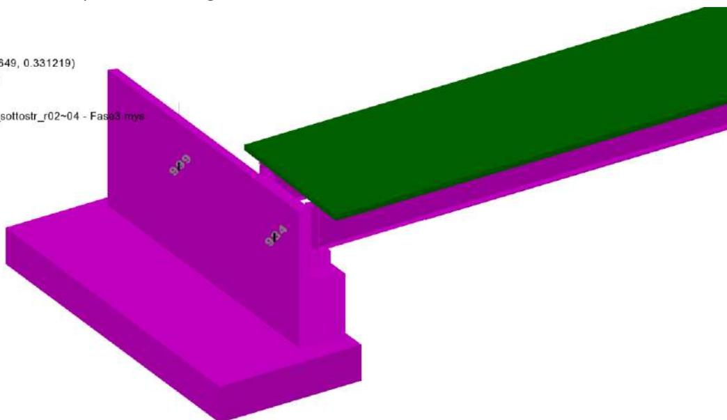
Figura 10.2 Elementi verifica sezione incastro paraghiaia
