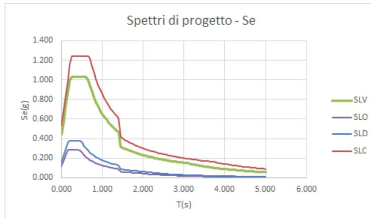
Figura 4.2: Spettro elastico per la componente orizzontale
