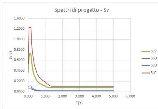
Figura 4.4: Spettro elastico per la componente verticale
