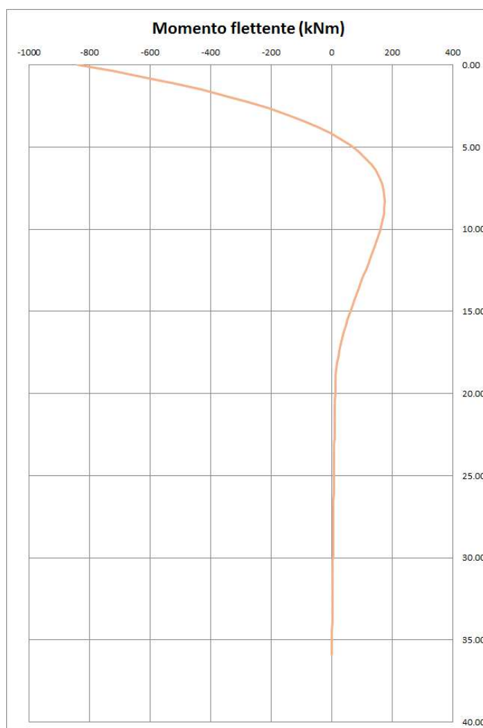
Figura 10.9 Andamento momento flettente lungo i pali - Pila 2
