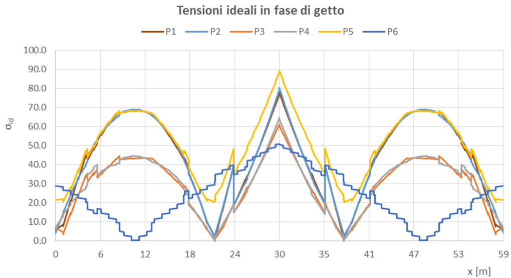
Figura 42 – Tensioni ideali in fase di getto
