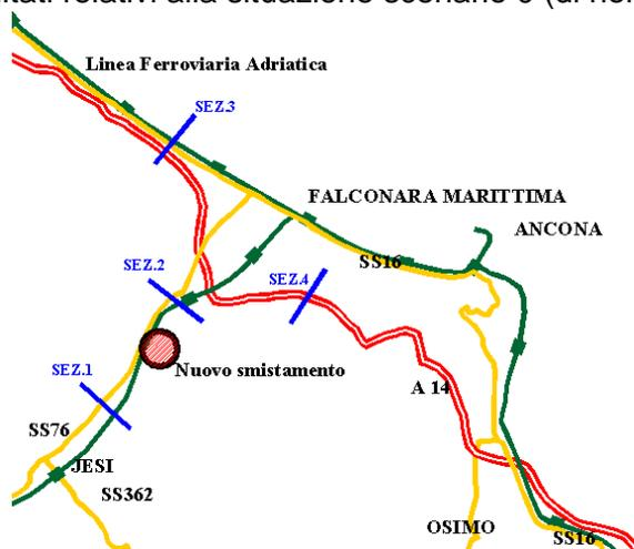
*Schema della rete stradale principale al servizio dell'area di intervento e localizzazione delle sezioni analizzate.*
