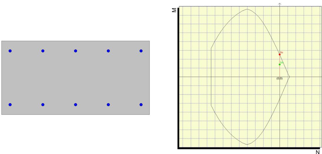
Figura 27 – Sezione S1 e domini di resistenza
