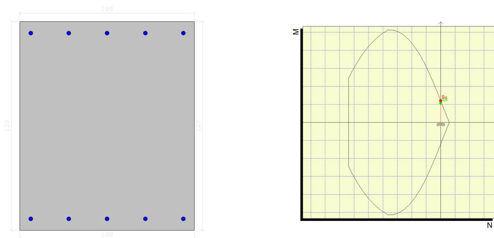
Figura 28 – Sezione S2 e domini di resistenza
