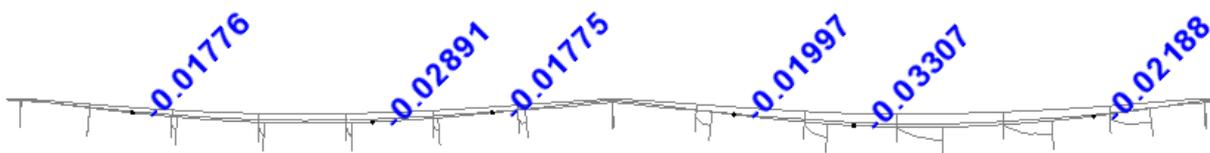
Figura 6.3: Deformata verticale carico da traffico (Fase 3b) nella travata destra
