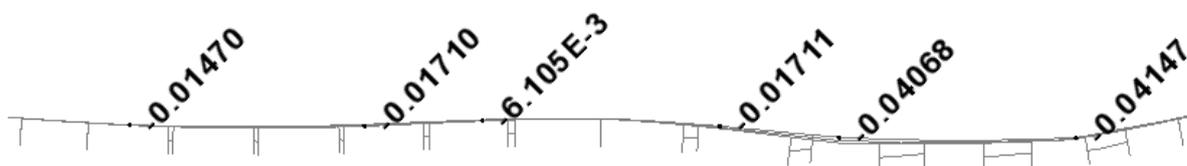
Figura 6.1: Deformata verticale peso proprio (Fase 1)
