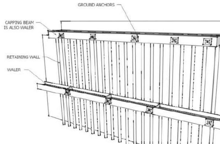
Il passo  $S$  dei tiranti corrisponde alla luce di calcolo della trave di ripartizione. Sia  $q$  la reazione, per unità di larghezza nel vincolo. La reazione complessiva  $Q$  nel tirante è quindi pari a
