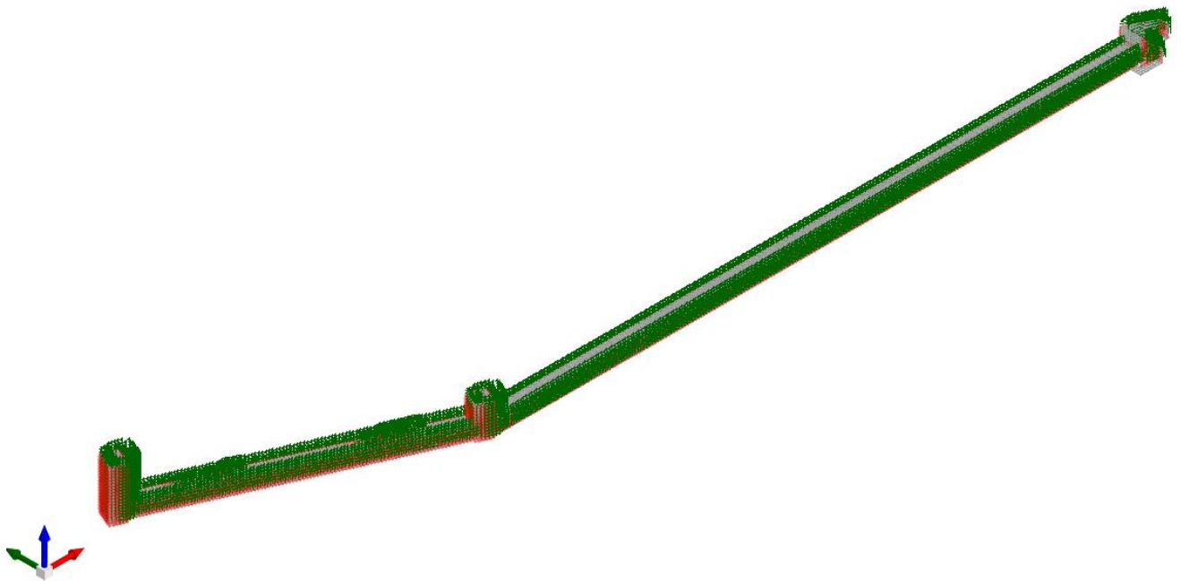
Figura 6 - Condizione sovraccarico variabile traffico (carichi distribuiti)
