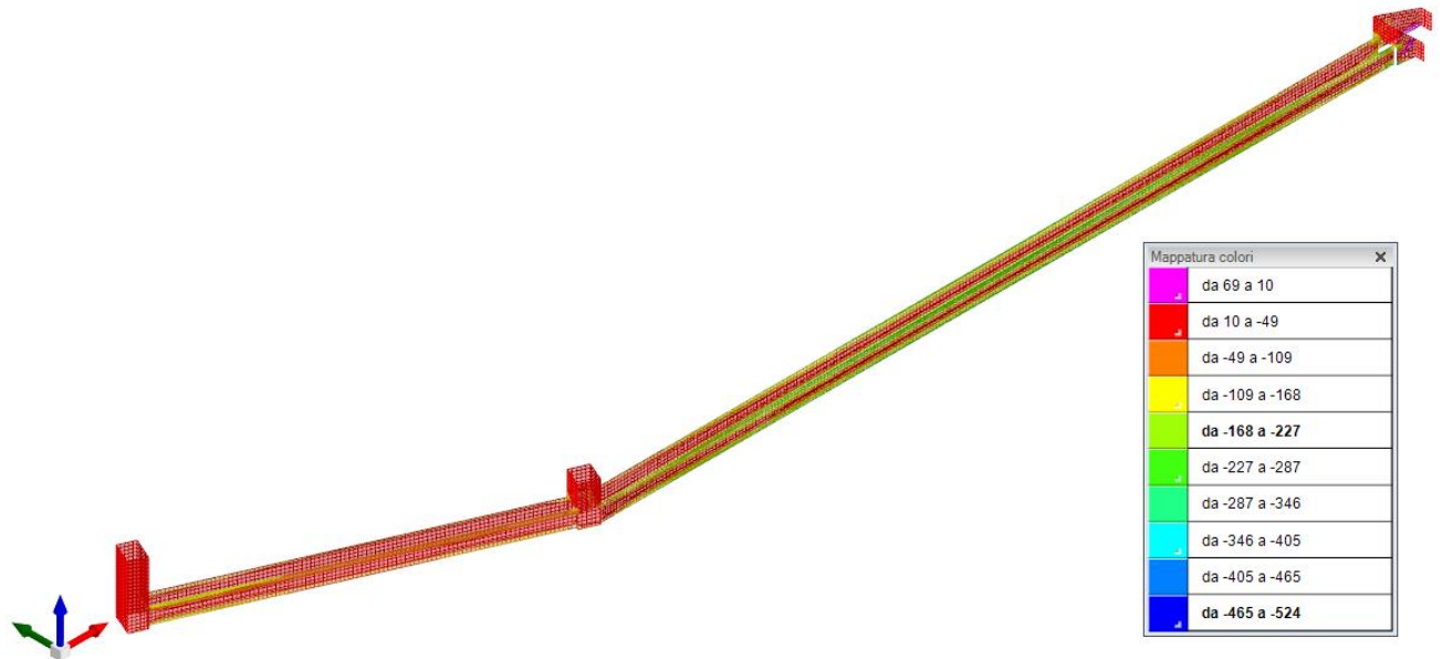
Figura 9 - Involuppo momento flettente Mzz (Involuppi SLU-SLV)
