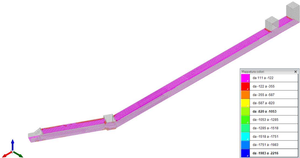
Figura 15 - Involuppo sforzo di taglio V_x (Involuppi SLU/SLV)
