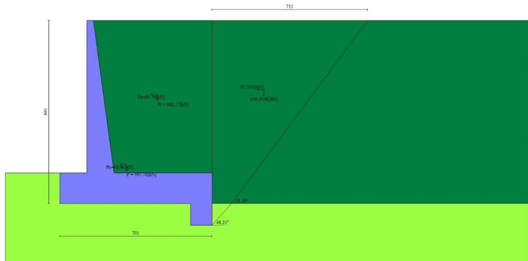
Fig. 5 - Cuneo di spinta (combinazione sismica) (Combinazione n° 2)
