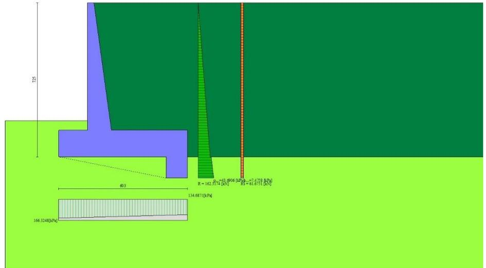
Fig. 6 - Diagramma delle pressioni (combinazione sismica) (Combinazione n° 2)
