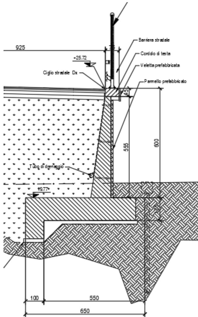
Figura 3: sezione trasversale dell'opera
