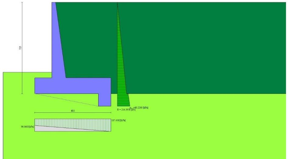
Fig. 4 - Diagramma delle pressioni (combinazione statica) (Combinazione n° 1)
