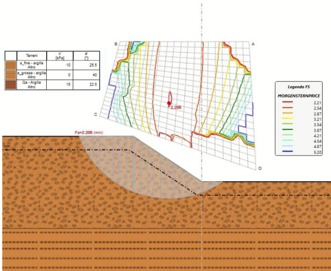
Figura 5: Verifica di stabilità globale in condizioni statiche.
