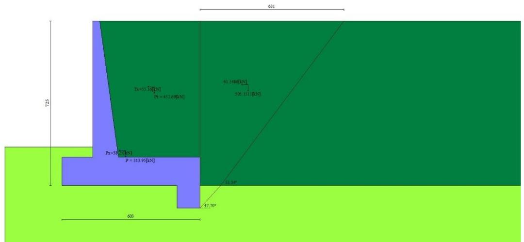
Fig. 5 - Cuneo di spinta (combinazione sismica) (Combinazione n° 2)
