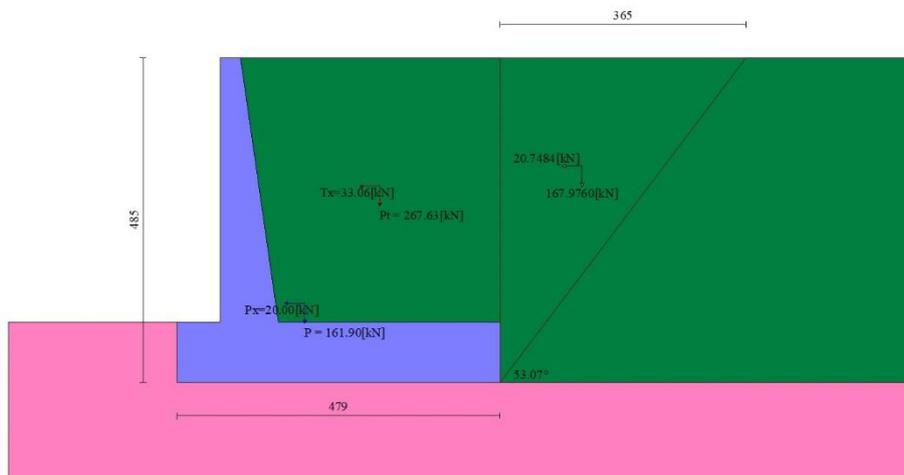
Fig. 5 - Cuneo di spinta (combinazione sismica) (Combinazione n° 2)
