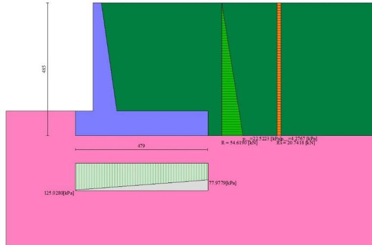
Fig. 6 - Diagramma delle pressioni (combinazione sismica) (Combinazione n° 2)
