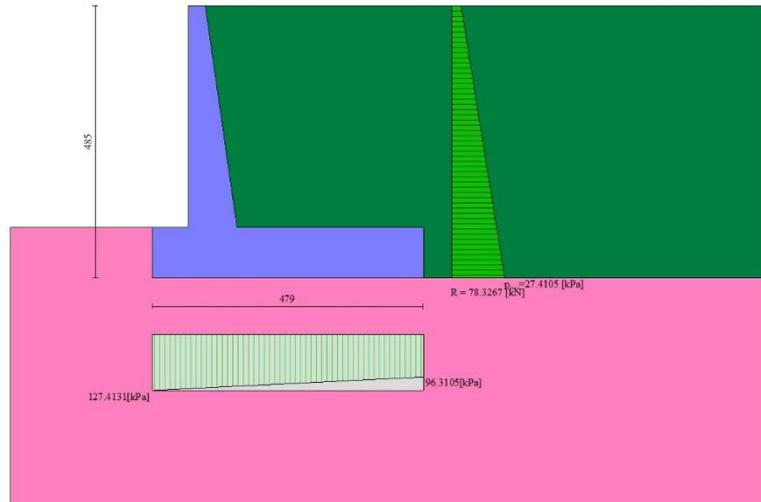
Fig. 4 - Diagramma delle pressioni (combinazione statica) (Combinazione n° 10)
