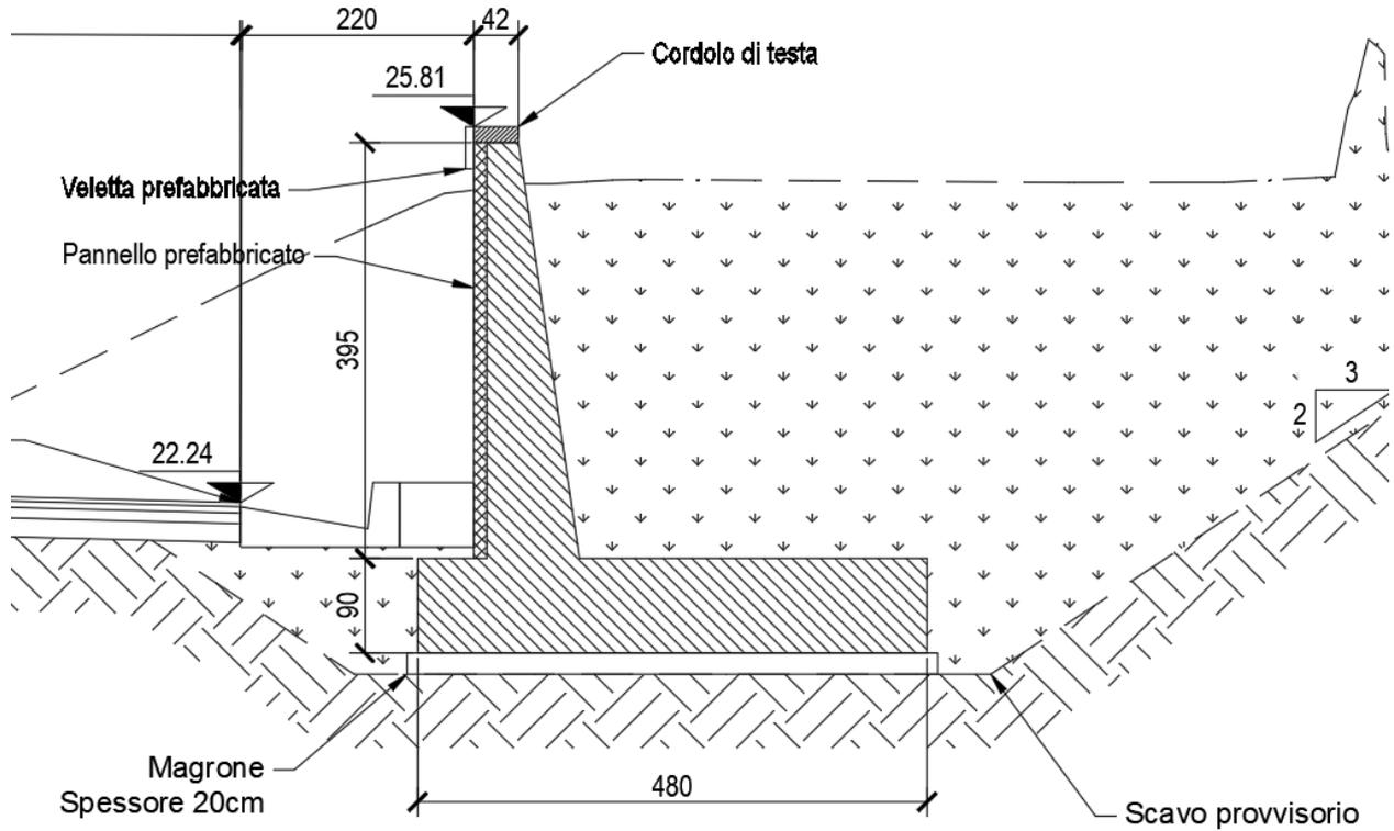
Figura 3: sezione trasversale dell'opera
