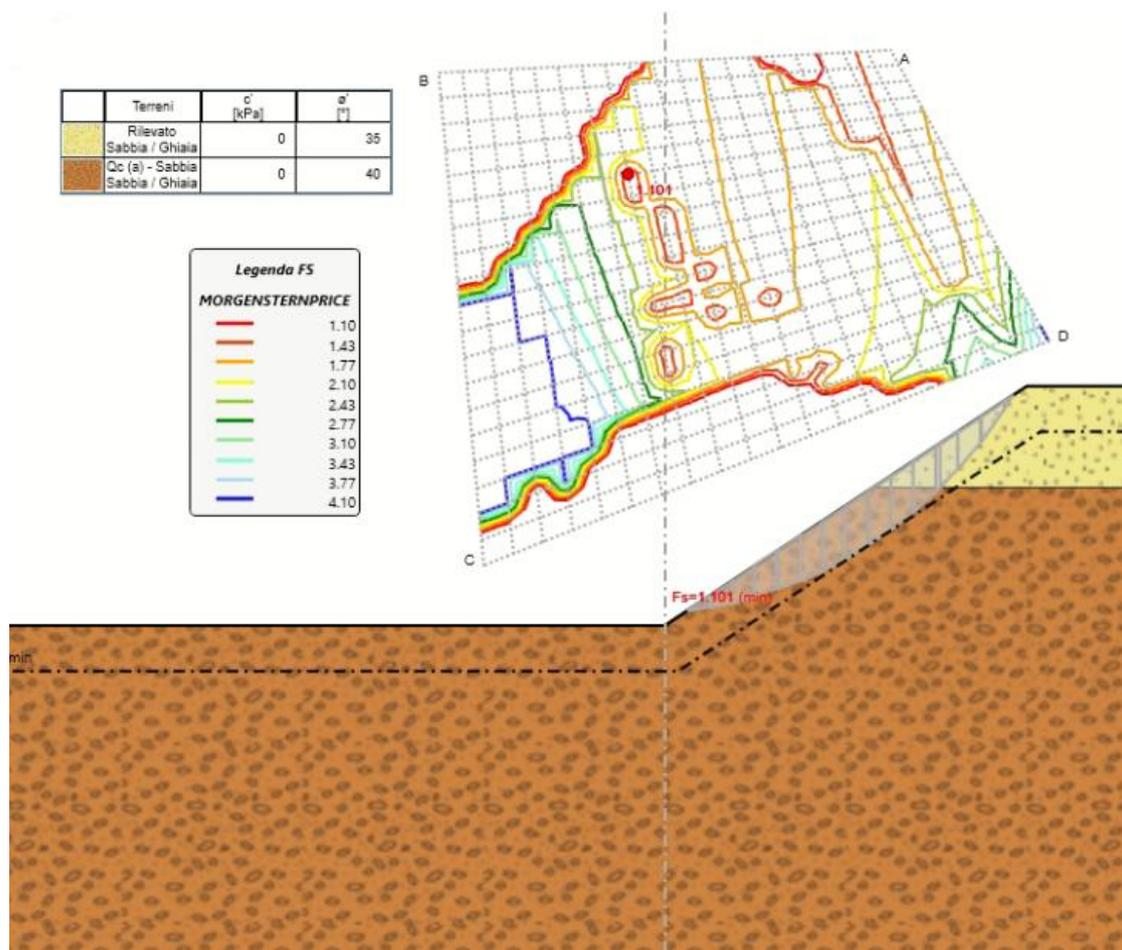
Figura 5: Verifica di stabilità globale in condizioni statiche.
