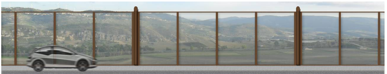
Figura E-6 Esempio di barriera antirumore
