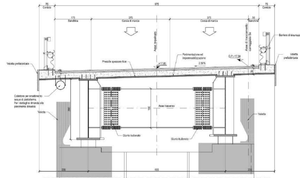
Come strategia di protezione sismica si è scelto di adoperare sistemi di isolamento con lo scopo di ridurre il livello di danneggiamento post-sisma e quindi l'entità degli interventi di retrofit e la probabilità che la strada vada fuori servizio. Il viadotto San Leonardo era isolato anche nel Progetto Definitivo ma è stata modificata la tipologia di dispositivi prevedendo isolatori elastomerici come gli altri viadotti invece che ad attrito.
