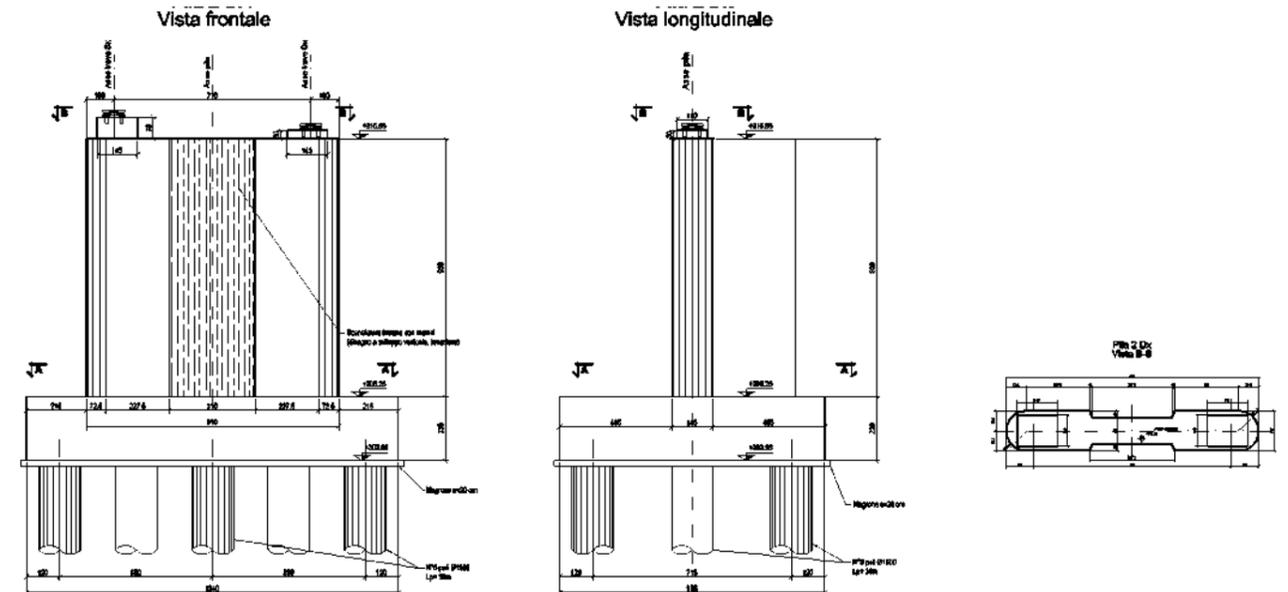
Nei casi in cui i viadotti presentano pile di altezza superiore a 22 m, pur mantenendo esteriormente un'analogha forma, le pile sono realizzate con sezione cava, al fine di offrire una maggiore inerzia in direzione longitudinale.
