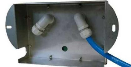
PLAFONIERA PER ILLUMINAZIONE VIA DI FUGA Dimensioni (LxHxP): 290x160x80 mm Alimentazione: 24 Vdc Assorbimento: 4W max Grado di protezione: IP 66 Fissaggio: a mezzo viti in acciaio inox
