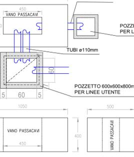
PARTICOLARE INSTALLAZIONE PALI ILLUMINAZIONE TIPOLOGICO IN PRESENZA DI BARRIERA DI SICUREZZA
