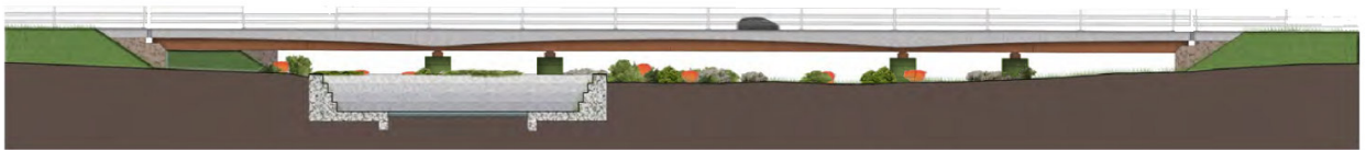
Figura 10 - Profilo longitudinale del Viadotto Margi – Lotto 4
