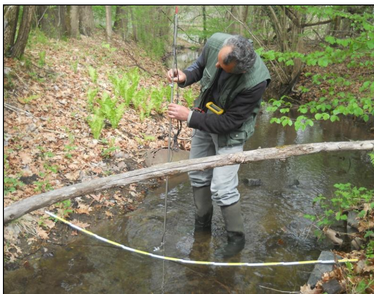
Figura 4.3/3 Misura di portata con micromulinello sulla Borra della Massa.
