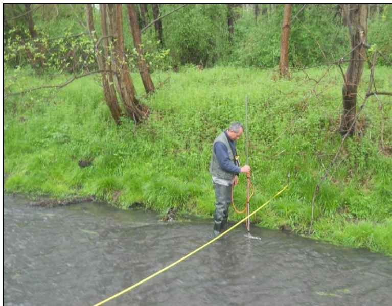
Figura 4.3/4 Misura di portata con mulinello ordinario sul rio Ribes.
