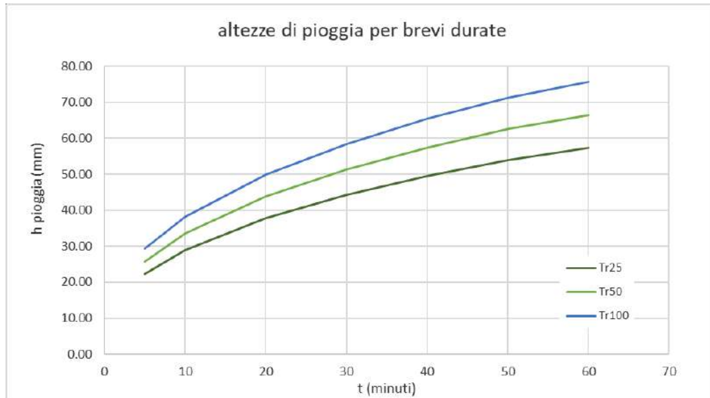
Fig. 7 – Curve di possibilità pluviometrica per brevi durate
