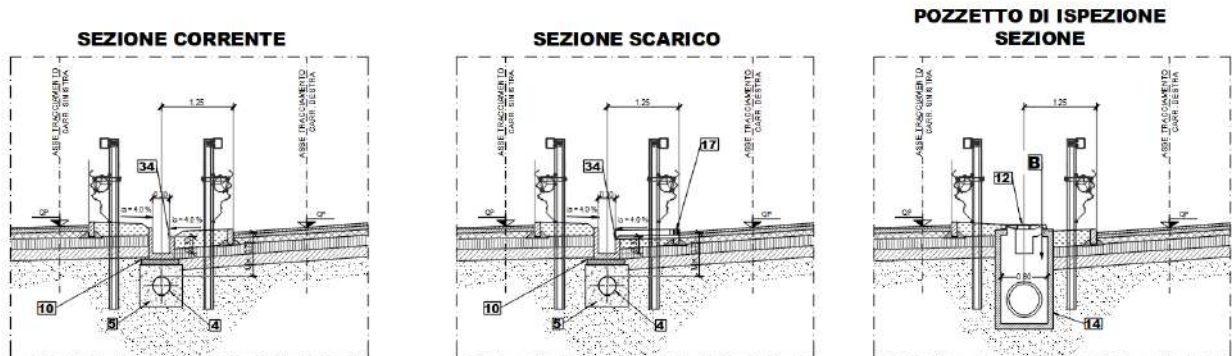
Fig. 2 – Dettagli idraulici – interno curva
