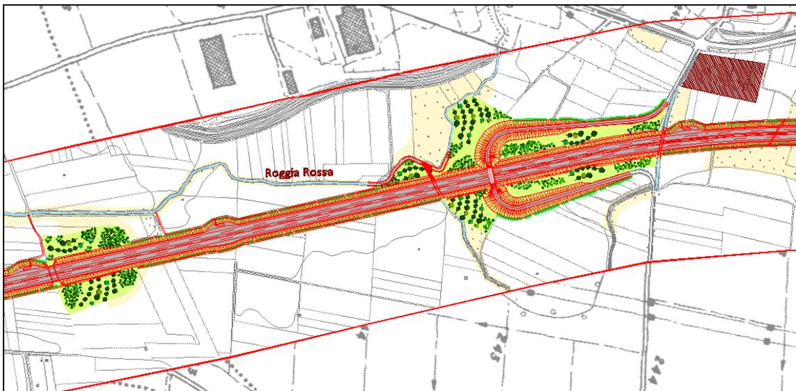
Demolizione sovrappasso al km 43+084 e realizzazione nuovo sovrappasso al km 43+787 (Lotto 3)
