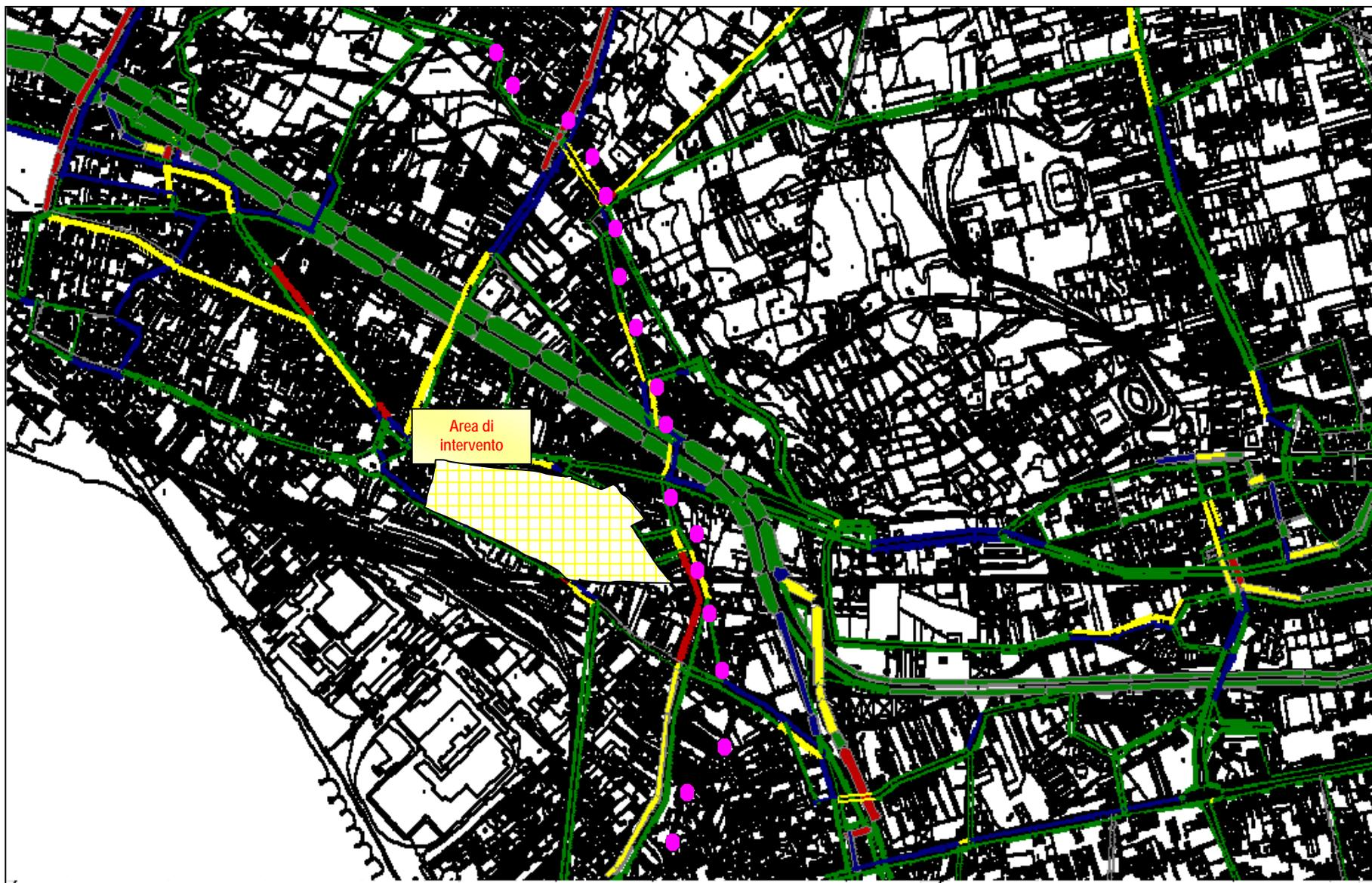
Figura 1.3.1.2 - Distribuzione dei flussi e relativo grado di congestione in prossimità dell'area di intervento – scenario futuro di progetto. Ora di punta della mattina
