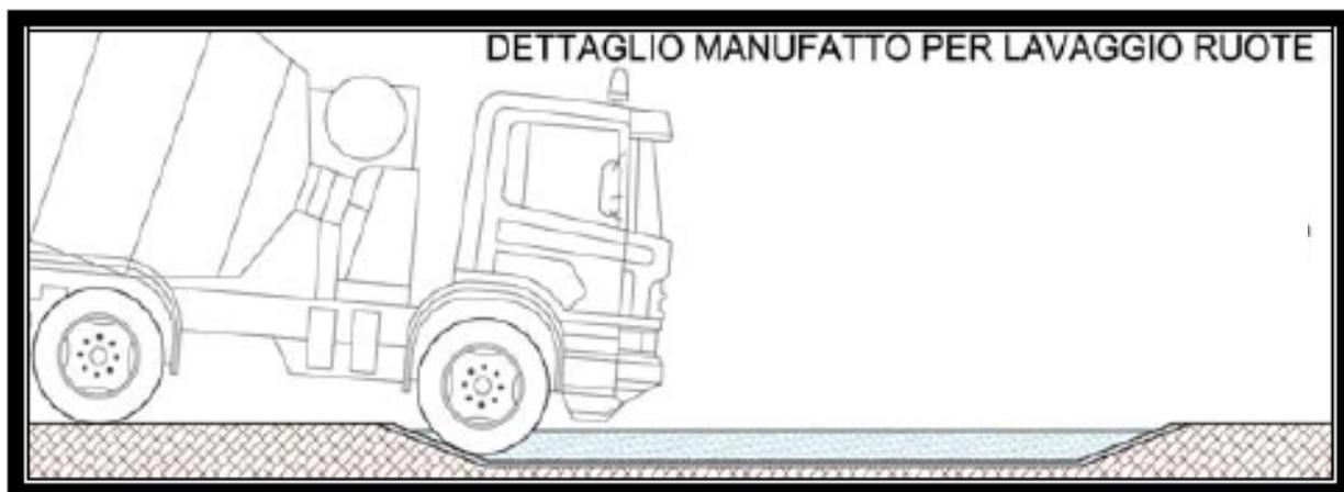
Figura 4.1.1 - Dettaglio manufatto per lavaggio ruote
