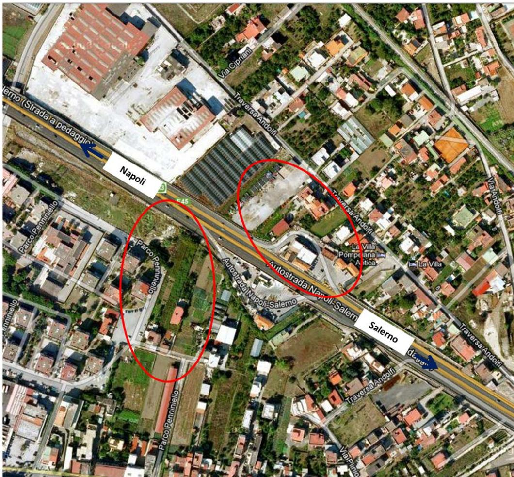
Figura 2.1.4 – Individuazione aree di intervento (nuove rampe di uscita autostrada NA-SA)
