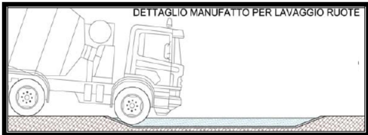
Figura 4.4.1 - Dettaglio manufatto per lavaggio ruote
